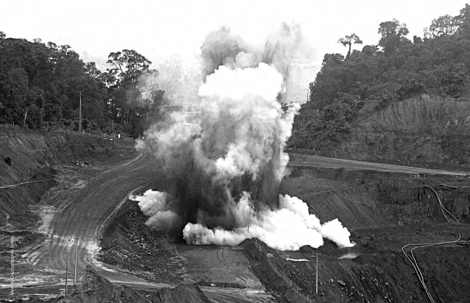
A extração do minério é realizada através de explosões: o platô se transforma em buraco e o vale em montanha
